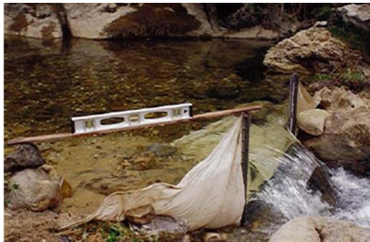
Figura 4. Aforo con aforador portátil rectangular
