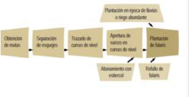
Figura 3. Metodología de implementación de terrazas de formación lenta con phalaris.
