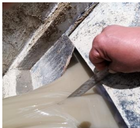
Figura 4. Forma de medir en cm. con regla metálica de 30 cm de largo
